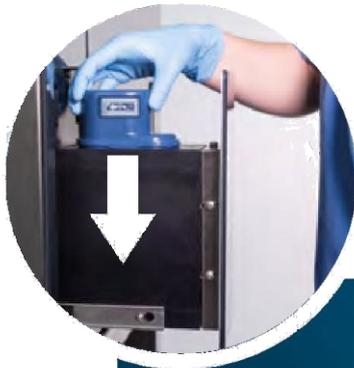
Стерилизатор оснащен отсеком с функцией автоматического вскрытия картриджа. Расположен с фронтальной стороны для удобства загрузки картриджей **BluKat®**. Форма картриджа гарантирует загрузку в нужном положении, что исключает ошибки при манипуляциях с картриджами.
