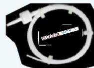
Helix-тест с индикатором 2 класса для проверки проникающей способности
